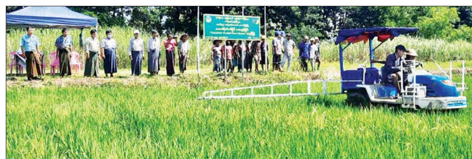
စမ်းသပ်သုတေသန ပြုလုပ်ထားသော Transplanter-mounted Boom Sprayer ကောက်စိုက်စက်ဖြင့် ပေါင်းသတ်ဆေးပျန်းခြင်းကို စက်ရုံမှူး ဦးဝင်းကျော်ဦး နှင့် ဝန်ထမ်းများက လက်တွေ့ပြသပြီး တောင်သူများ မြေပြင်၊ ပျိုးထောင်၊ စိုက်ပျိုး၊ ဆေးပျန်း၊ ရိတ်သိမ်းခြင်းများကို ဌာနမှ ကူညီဆောင်ရွက်ပေး နိုင်ကြောင်း ရှင်းလင်းပြောကြားသည်။ ခရိုင် (ပြန်/ဆက်)
