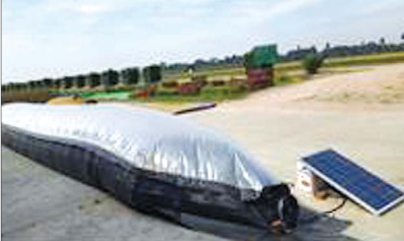
နေရောင်ခြည်စွမ်းအင်သုံးအခြောက်ခံစက် (Solar Bubble Dryer) ကိုအသုံးပြုခြင်းဖြင့် စပါးမျိုးများ အခြောက်ခံခြင်း။
