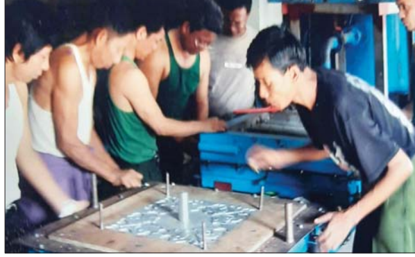
လေဟာနယ်သံသွန်းအခြောက်အတွင်း ပုံဖော်ဆောင်ပေးမည့် ကနုတ် ထုတ်ဆစ်ထားသည့်ပုံ (Pattern)ကို အောက်ခံပလတ်ပြား (Pattern Plate) တွင် ကပ်တွဲပေးနေခြင်း
