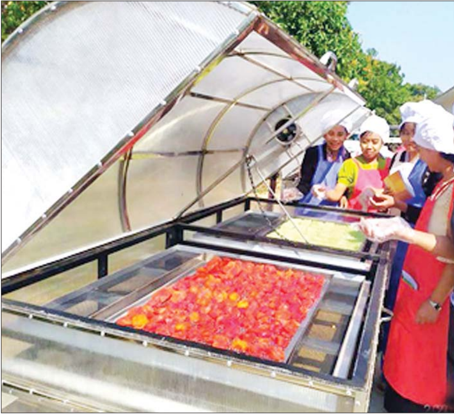
အသေးစား နေရောင်ခြည်သုံး အခြောက်ခံစက် Mini Solar Dryer
