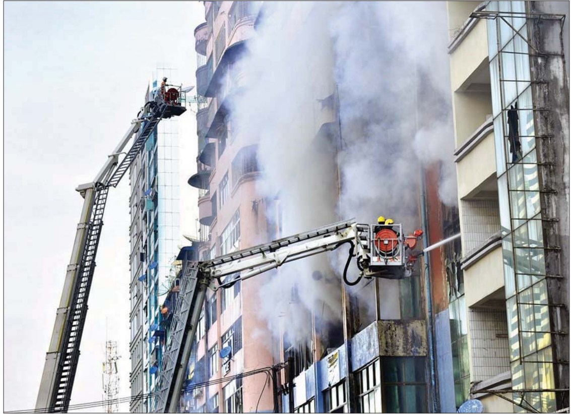
25 meter Hydraulic Platform ယာဉ်ဖြင့် မီးငြိမ်းသတ်ပြီး 48 meter Hydraulic Platform ယာဉ်ဖြင့် ရှာဖွေကယ်ဆယ်ရေးလုပ်ငန်းများ တစ်ပြိုင်နက်တည်း ဆောင်ရွက်နေစဉ်။
