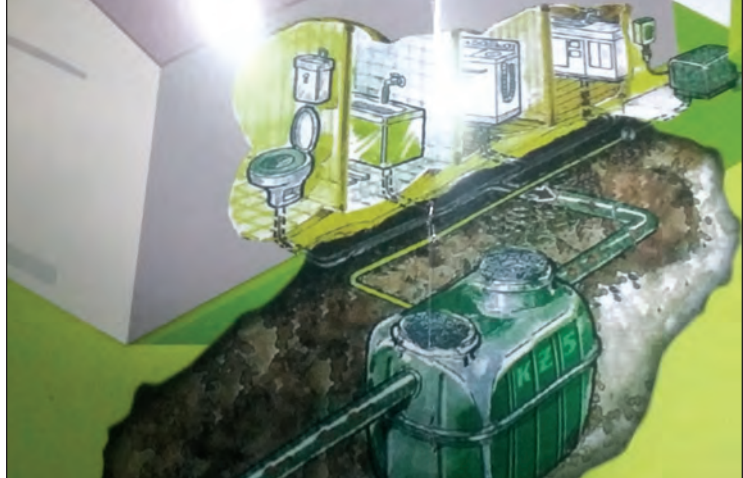
KZ-5 ရေဆိုးသန့်စင်စက် တပ်ဆင်မည့် သရုပ်ပြပုံစံ
