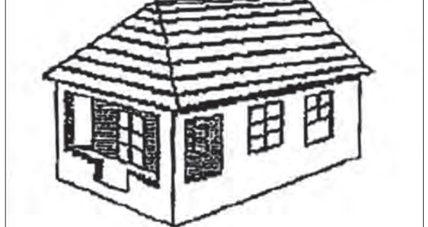
အမိုးအား Hip Roof ပုံစံဖြင့်ဆောက်လုပ်ထားပုံ
