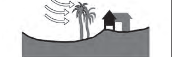
လေမုန်တိုင်းဒဏ်ကာကွယ်ရန် သစ်ပင်ကို ကွယ်၍ အဆောက်အအုံဆောက်လုပ်ထားပုံ
