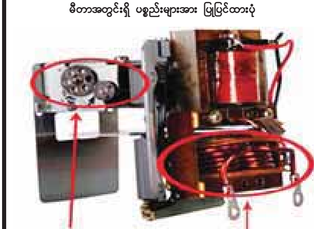
မီတာအတွင်းရှိ ပစ္စည်းများအား ဖြုတ်ထားပုံ Counter ပင်နယ်သွားအချို့အား ကျောက်စက်ဖြင့် စားထားပုံ ကြိုးမားလှသော Current Coil ကြိုးဖြင့် လဲလှယ်ထားပုံ
