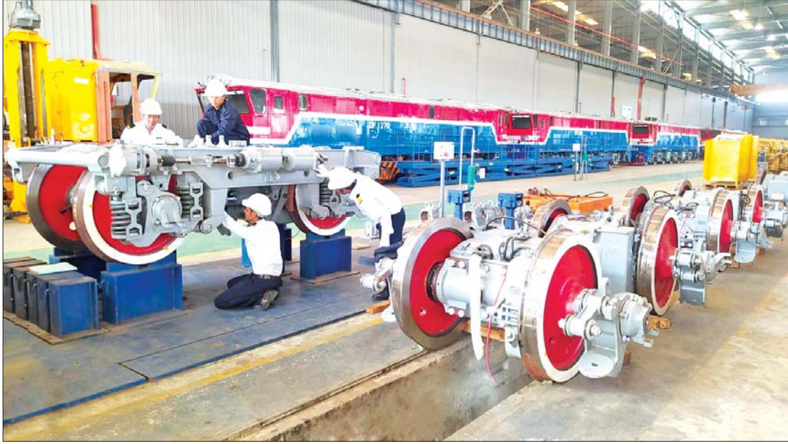
နေပြည်တော်စက်ခေါင်းသစ်တပ်ဆင်ထုတ်လုပ်ရေးစက်ရုံမှ မြင်းကောင်ရေ ၁၂၀၀ ဒီဇယ်လျှပ်စစ်စက်ခေါင်းသစ် သုံးခေါင်း တည်ဆောက်ထုတ်လုပ်နေမှုမှတ်တမ်း။
