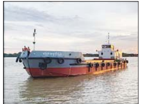
မြေခဲ-၂ ရေယာဉ်(250 m3 Split Hopper barge)
