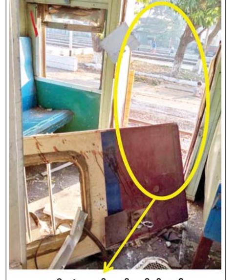
လူစီးတွဲ တက်/ဆင်းပေါက်တံခါး ပြုတ်ကျပျက်စီးမှုအခြေအနေ။
