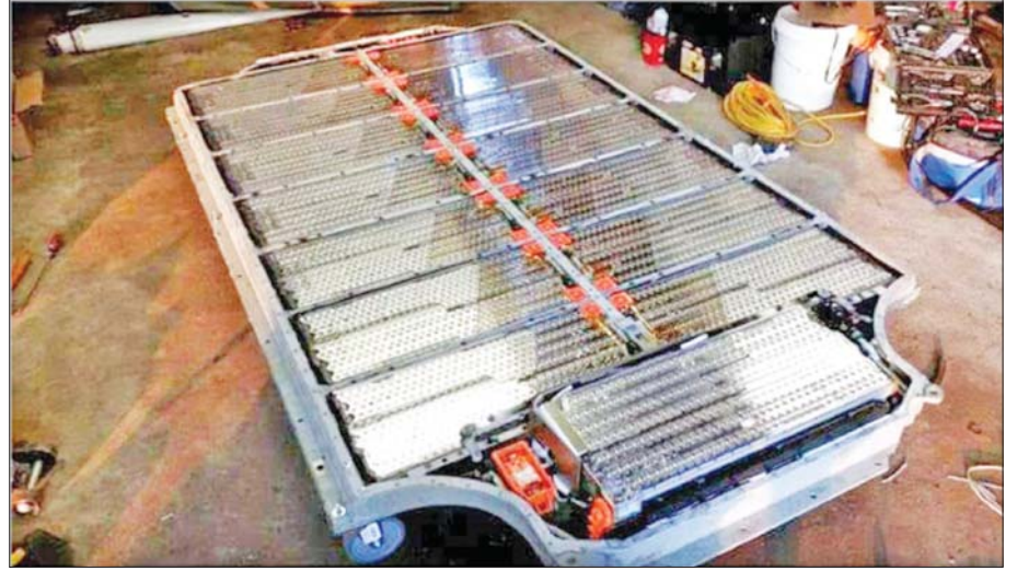
လျှပ်စစ်သုံးမော်တော်ယာဉ် ဘက်ထရီတည်ဆောက်ပုံ။
