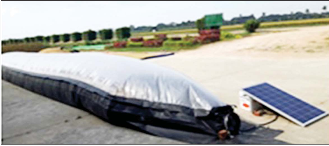
နေရောင်ခြည်စွမ်းအင်သုံးအခြောက်ခံစက် (Solar Bubble Dryer) ကို အသုံးပြု၍ စပါးမျိုးများ အခြောက်ခံစဉ်။
