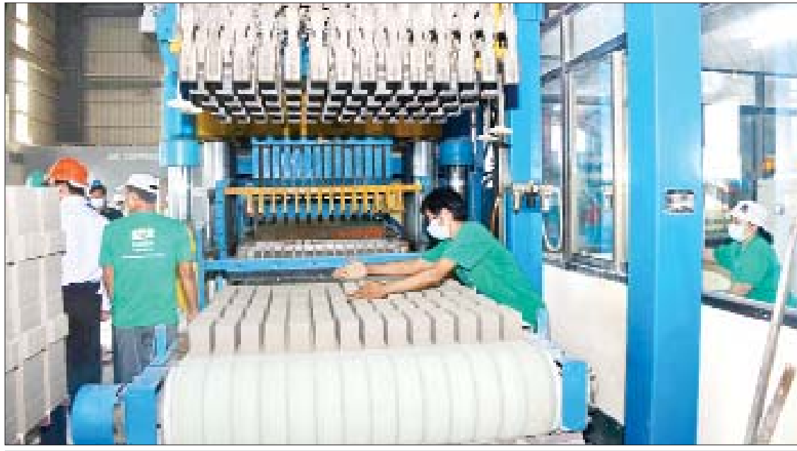
Mother Industrial Co.,Ltd. စက်ရုံအတွင်း AAC နှင့် APC ကွန်ကရစ်တုံးများ ထုတ်လုပ်နေမှုကို တွေ့ရစဉ်။
