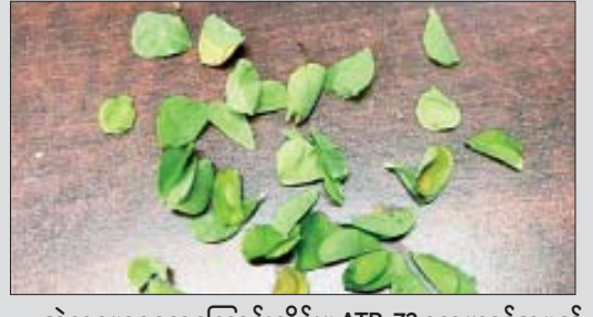
အဲကမ္ဘောဇလေကြောင်းလိုင်းမှ ATR-72 လေယာဉ်အမှတ် (XY-AMN)၏ ဘယ်ဘက်နှင့် လေယာဉ်အမှတ် (XY-AMN)၏ ညာဘက် Pitot Tube အတွင်း တွေ့ရှိရသည့် သစ်ရွက်များကို တွေ့ရစဉ်။
