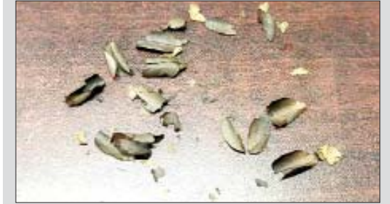
အဲကမ္ဘောဇလေကြောင်းလိုင်းမှ ATR-72 လေယာဉ် အမှတ်(XY-AM0)၏ ဘယ်ဘက်နှင့် Pitot Tube အတွင်း တွေ့ရှိရသည့် သစ်ရွက်များကို တွေ့ရစဉ်။
