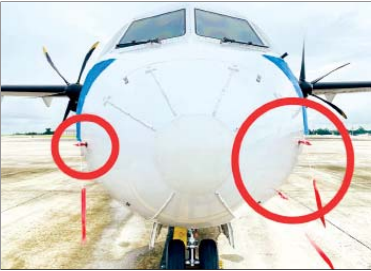
အဲကမ္ဘောဇလေကြောင်းလိုင်းမှ ATR-72 လေယာဉ်တွင် Pitot Tube တပ်ဆင် ထားသည့် နေရာများ၏ မှတ်တမ်းဓာတ်ပုံကို တွေ့ရစဉ်။
