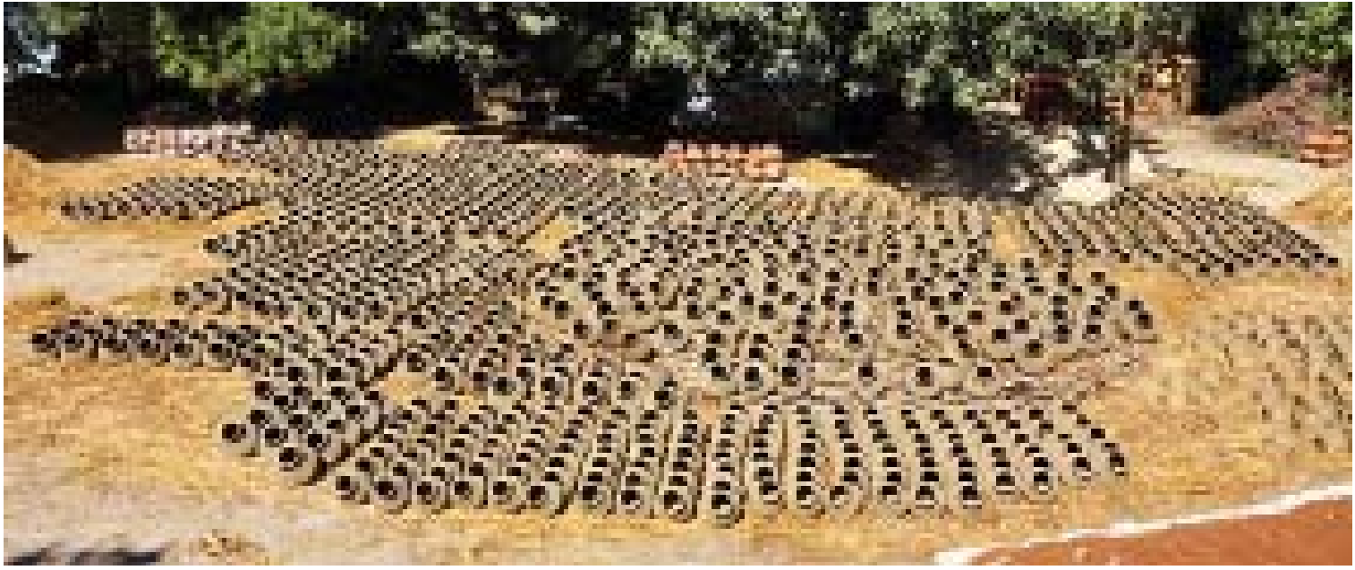
အိုးမဖုတ်မီ အိုးများကို နေလှန်းအခြောက်ခံထားစဉ်။
