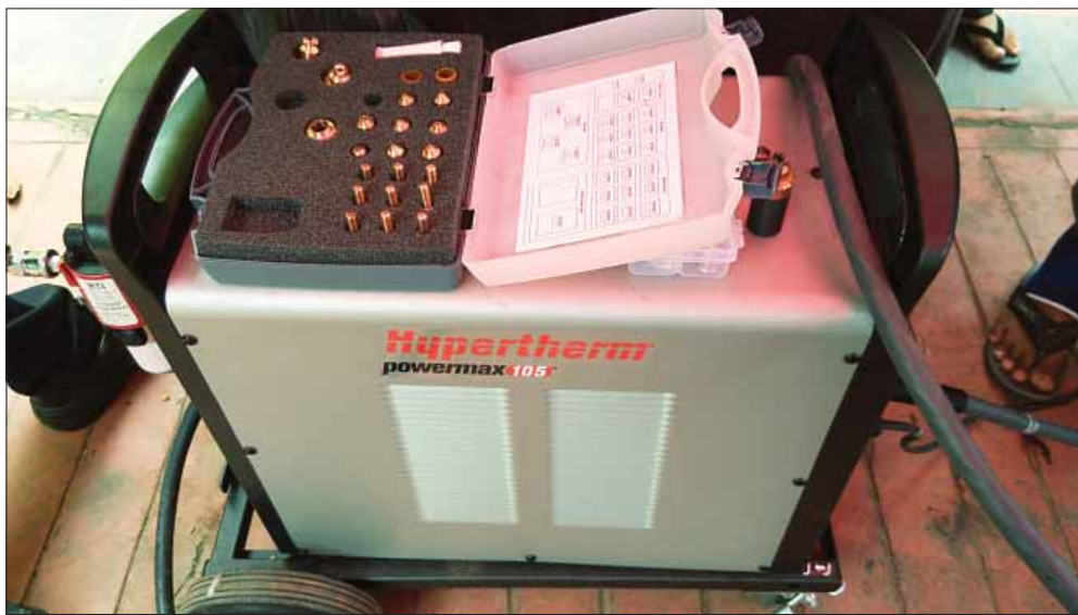
အမေရိကန်နိုင်ငံထုတ် ကုန်ပစ္စည်းဖြစ်သည့် Hypertherm Powermax သံနှင့် သံမဏိဖြတ်စက်အား တွေ့ရစဉ်။
