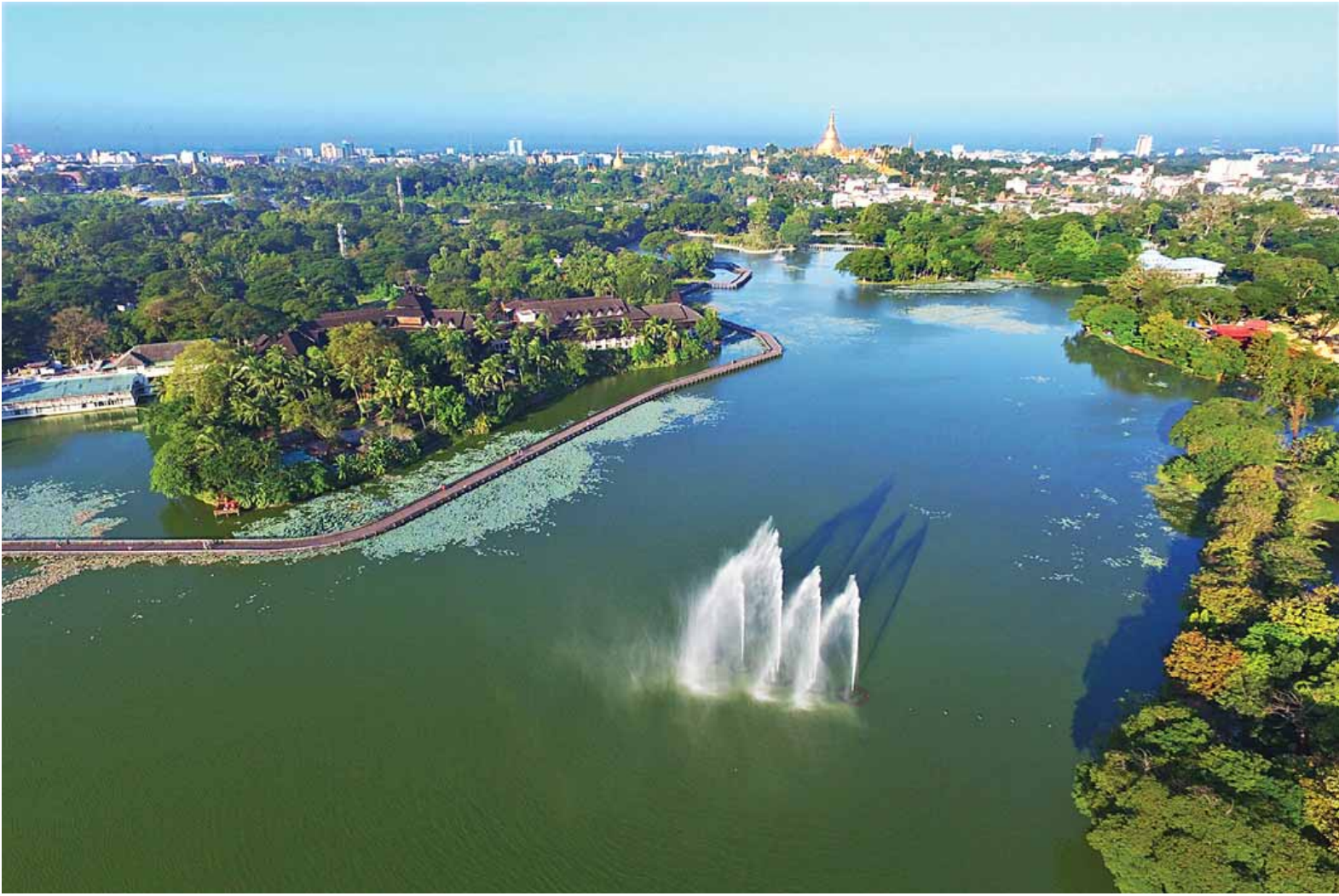
ကန်တော်ကြီး သဘာဝဥယျာဉ်အတွင်း ရေပြင်၌ အောက်စီဂျင်ပျော်ဝင်မှုများပြားစေရန် ရေပန်းများ တပ်ဆင်ထားစဉ်။
