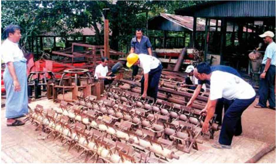
လယ်ယာစိုက်ပျိုးရေးနှင့် ဆည်မြောင်းဝန်ကြီးဌာန စက်မှုလယ်ယာဦးစီးဌာနရုံးချုပ်၏ အစီအစဉ်ဖြင့် မကွေးတိုင်းဒေသကြီး ပွင့်ဖြူမြို့နယ် ရေဘေးသင့်လယ်ယာမြေများတွင် မိုးစပါးအချိန်မီစိုက်ပျိုးနိုင်ရေး အခမဲ့မြေပြင်ပေးခြင်းဆောင်ရွက်ရာတွင် ထွန်စက်ကြီးများနှင့် တွဲဖက်တပ်ဆင်အသုံးပြုမည့် နှစ်တန်းသွားစက်တုံးများကို အမှတ်(၁)ပင်မစက်ပြင်အလုပ်ရုံ (ကျိုက္ကလုံ) မင်္ဂလာဒုံစက်ရုံမှဦးကျော်ဝေ၏ အနီးကပ်ကြီးကြပ်မှုဖြင့် ပြုပြင်ပေးပြီး ရန်ကုန်မှ ပွင့်ဖြူသို့ ပို့ဆောင်ရန် ဩဂုတ် ၁၅ ရက်က ကားများပေါ်သို့ တင်ဆောင်နေစဉ်။ (ဝင်းမင်း)
